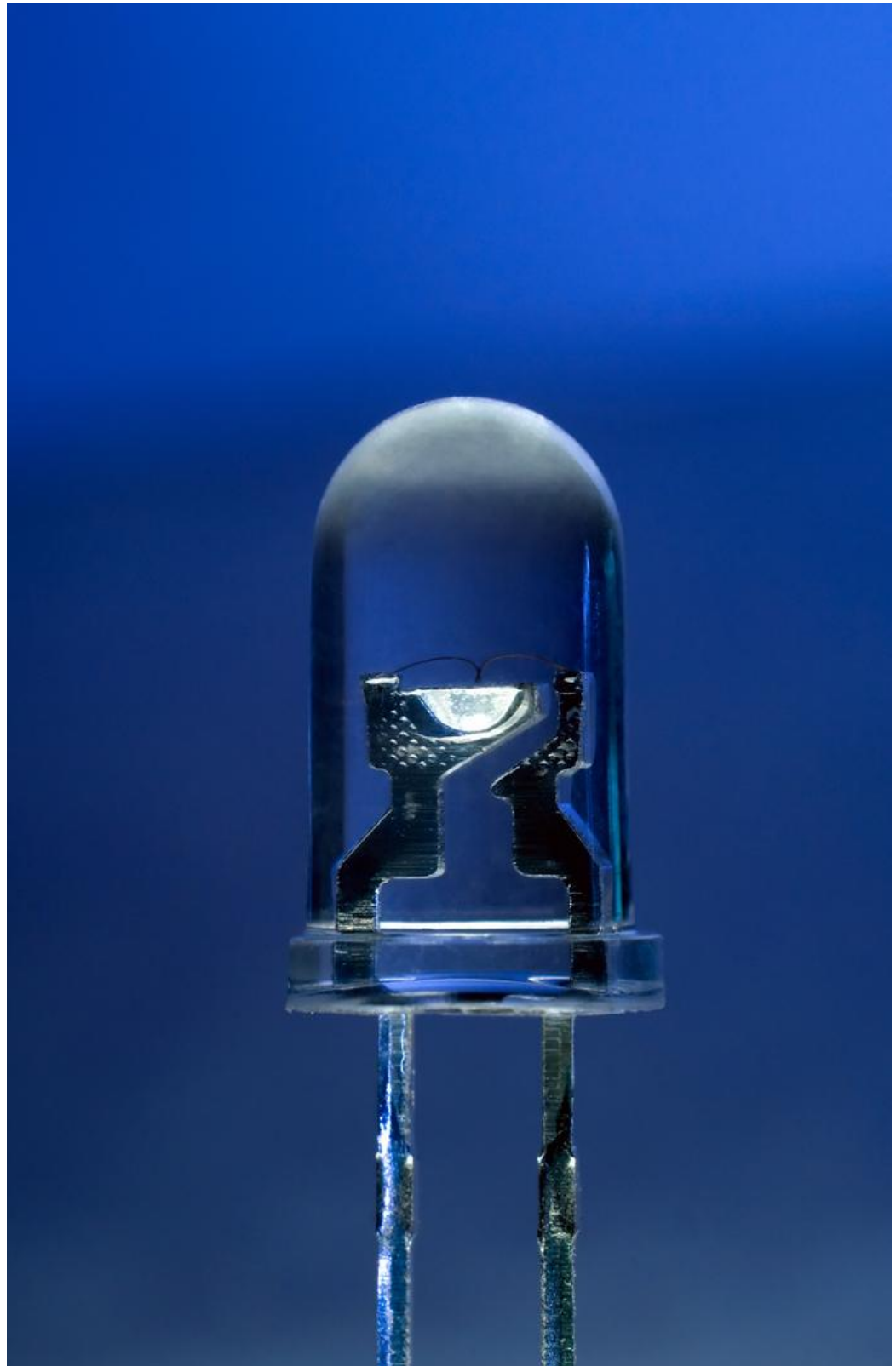
Een led: light emitting diode
